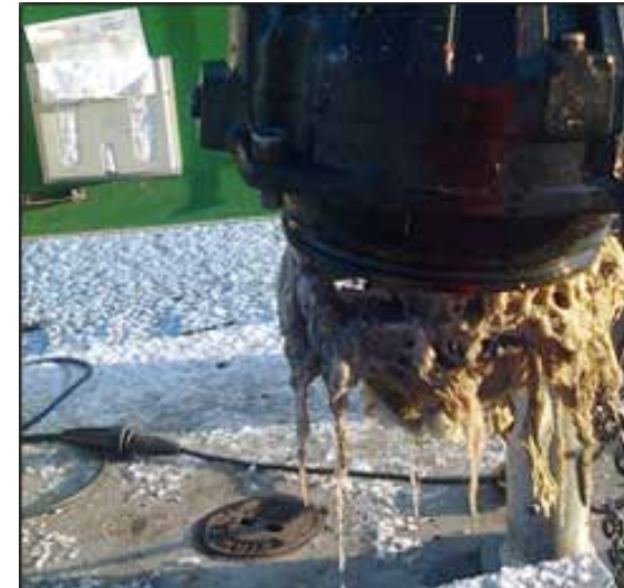
Afbeelding 3-6. Verstopping van een pomp door doekjes
